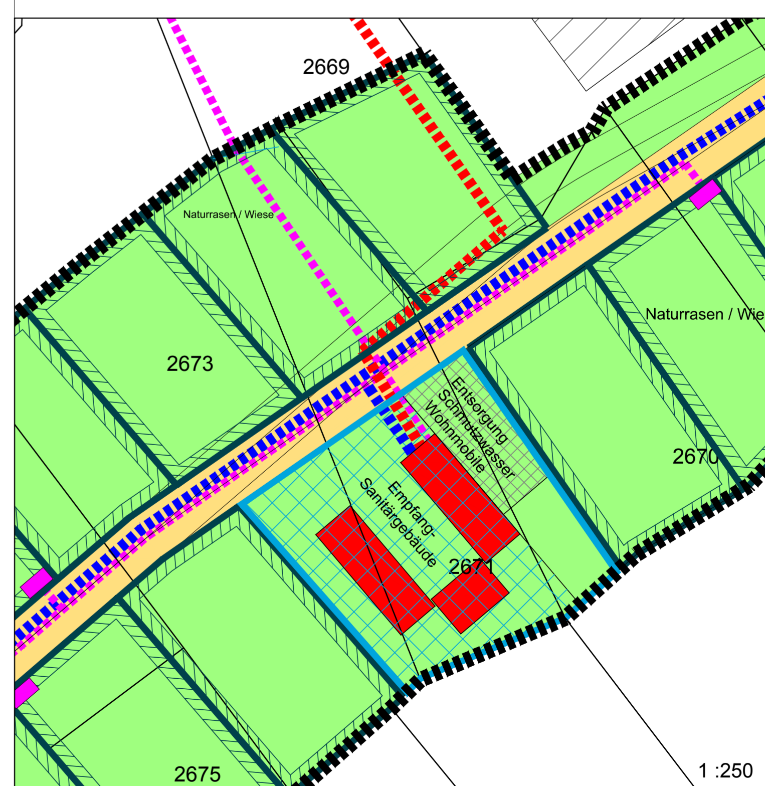
Detail: Beispiel Gestaltung Sanitärgebäude mit Empfangsstrukturen
